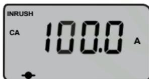
**Nota:** En la pantalla de armónicos, la tecla INRUSH se utiliza para desplazarse por los armónicos. El modo Inrush no puede activarse en la pantalla de armónicos.
