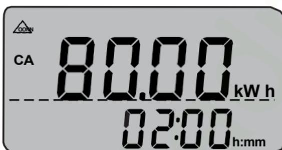
**Nota:** Para kWh en el sistema de corriente continua, pulse prolongadamente (>2 segundos) la tecla de función amarilla
