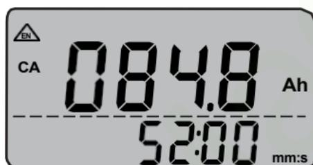
**Nota:** Para **Ahr en corriente continua**, pulse prolongadamente (>2 Segs) la tecla de función amarilla y la pinza amperimétrica entrará en modo corriente continua. Ahora pulse **REL y INRUSH** simultáneamente, la pinza amperimétrica empezará a medir amperios hora en corriente continua.
